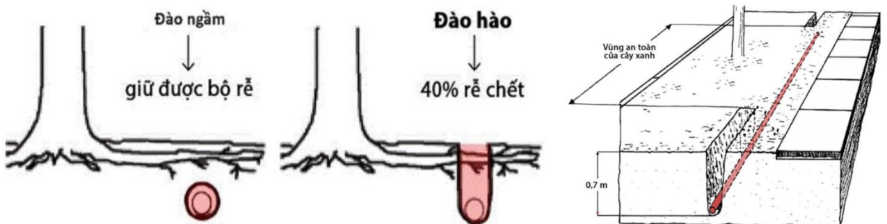
Giải pháp khi phải đặt ống kỹ thuật đi qua vùng rễ (vùng dưới tán cây xanh)
