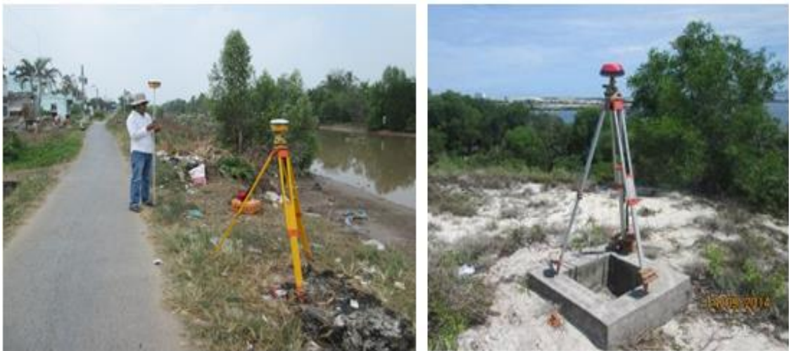
Hình 23: Hình ảnh công tác đo đạc bằng máy GPS RTK T300
