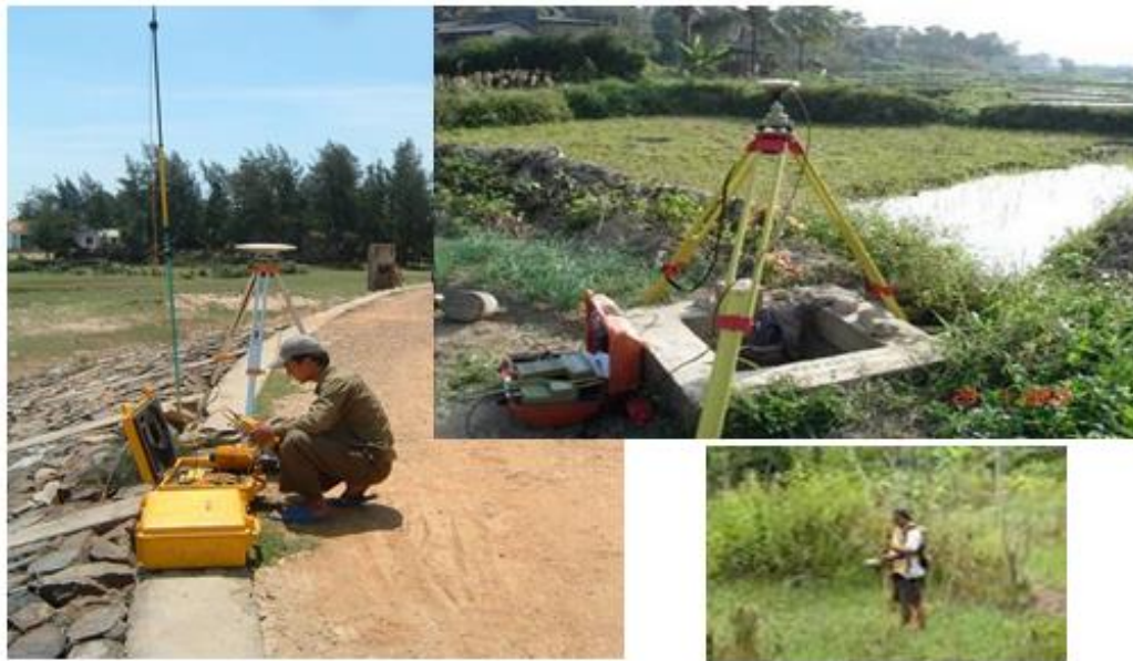
Thiết lập trạm Base và đo địa hình trên cạn bằng kỹ thuật RTK
