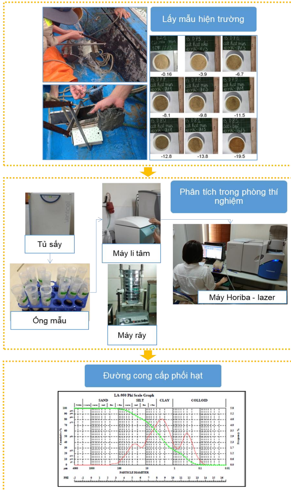
Hình 32. Sơ đồ phân tích mẫu bùn cát đáy xác định cấp phối hạt
