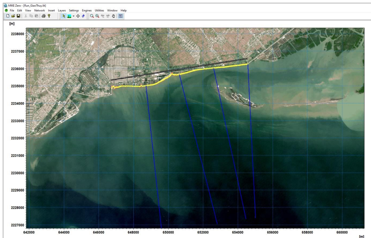
Hình 78. Mô hình Litpack tính toán sạt lở bờ biển dài hạn huyện Giao Thủy
